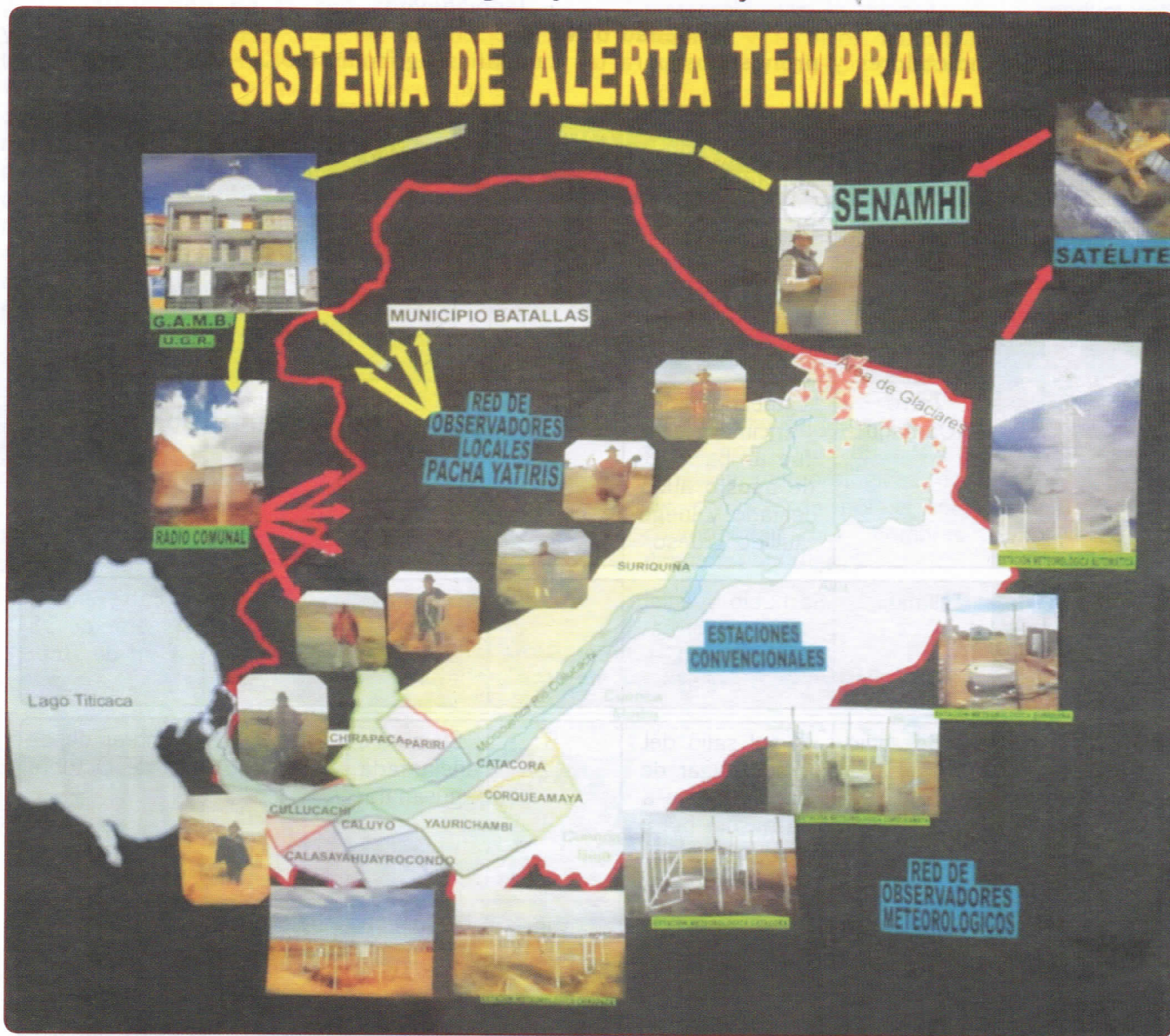
Gráfico No. 10 Concepto de Sistema de Alerta Temprana compuesto por la red de Estaciones Meteorológicas y red de Pachayatis
